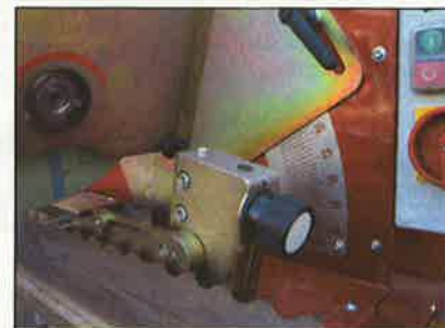
Einstellschraube für den Vorschub und die dahinterliegende Skala für die Einstellung des Brustwinkels am „Shark 200“
