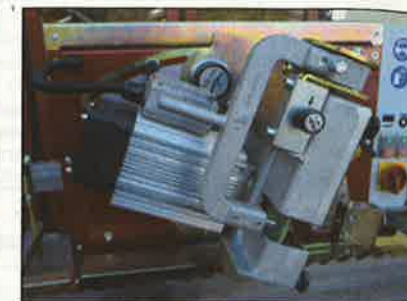
Große Schleifscheibe mit 300 mm Durchmesser und Abzieher für das optimale Schleifprofil
