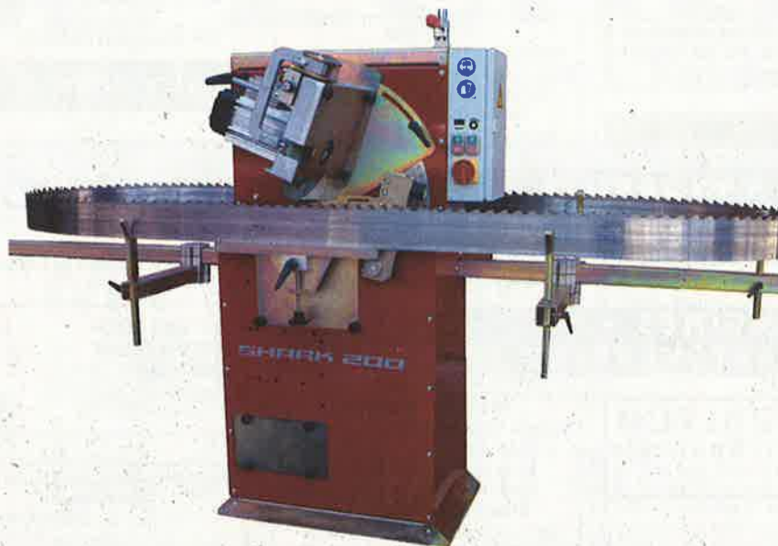
Innovation in der Trockenschleiftechnik: Der „Shark 200“ mit großer Schleifscheibe, integrierter Absaugung und einem Schleifscheibenabzieher
